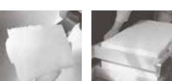
釜焚き製法の石けんには油脂に含まれる保湿成分グリセリンがほどよく残ります。 杣に流して一夜夜冷やし固めた後、ひとつひとつステンレス線で切り分けます。
